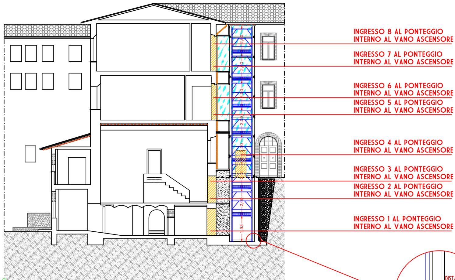
**SCHEMA DI MONTAGGIO PONTEGGIO FASE 2
